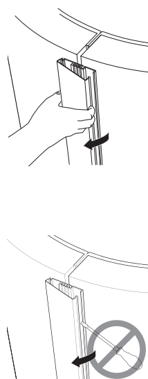
Använd inga verktyg för demontering av skarvskenan
